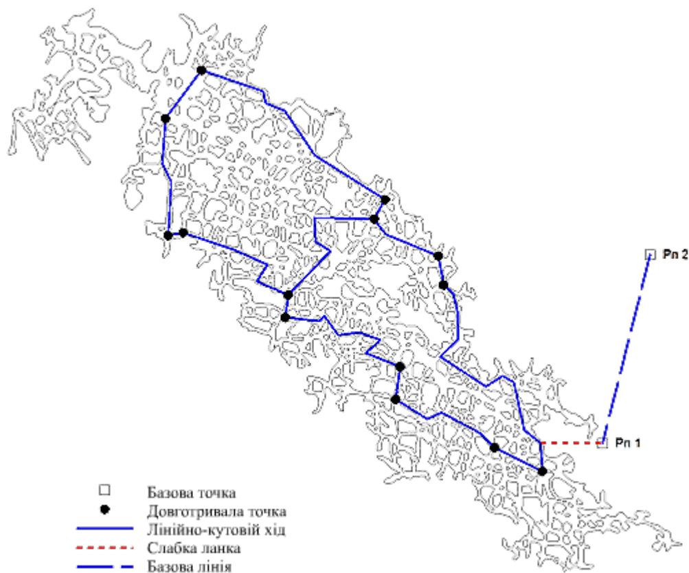
Малюнок 6. Проект опорної геодезичної мережі на прикладі печери Вертеба.
